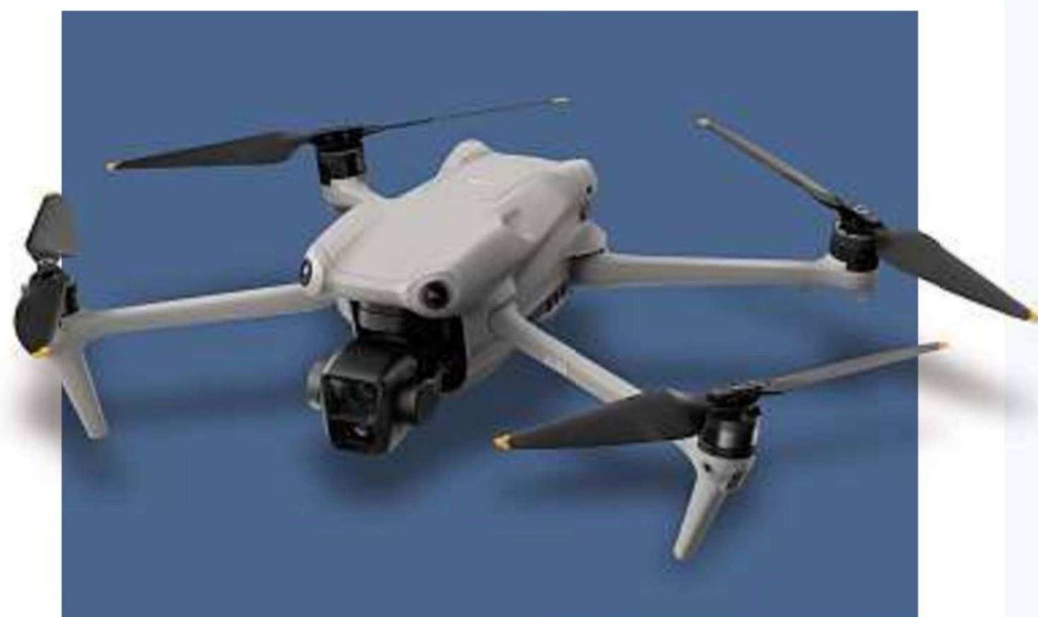
Die DJI Air 3 gehört zur Klasse C1 und darf in der Kategorie OPEN A1 fliegen.
