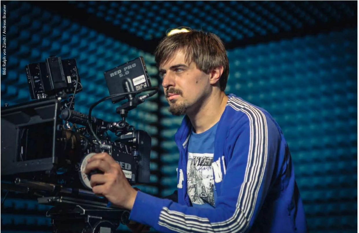
Eine Red One mit viel Zubehör beim Dreh. Die eigentliche Kamera ist nur der kleine Kasten rechts hinter der Hand des Kameramanns.
