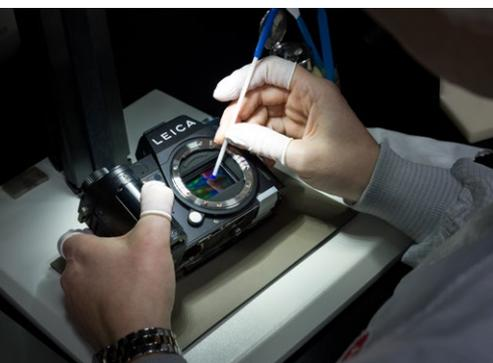
» Der rückseitig belichtete BSI-Bildsensor kommt ohne Tiefpassfilter aus und löst 60 Megapixel bei ISO 50 bis 100.000 auf.
