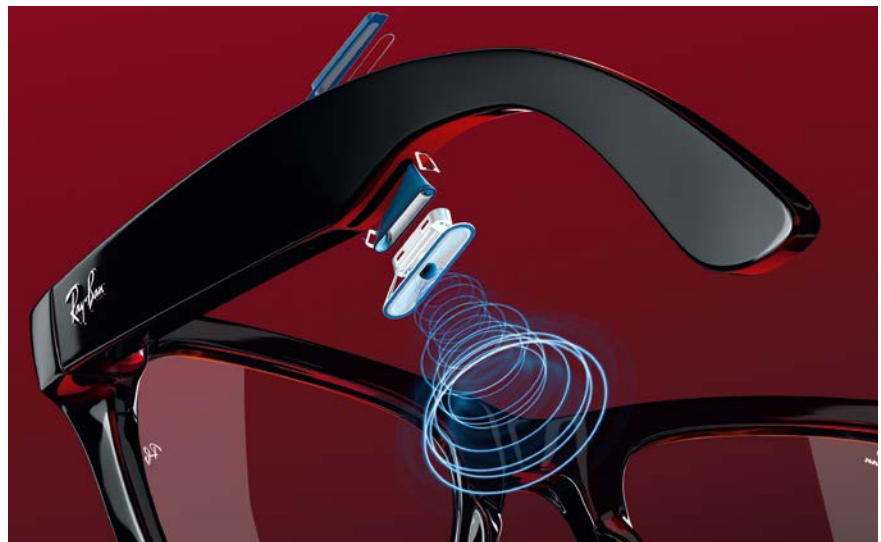
In jedem der beiden Brillenbügel ist ein winziger Lautsprecher versteckt, der per Bluetooth 5.3 Musik oder andere Klänge des Smartphones wiedergibt. Gemeinsam mit den Mikrofonen der Ray-Ban | Meta ergeben die zwei eine Telefon-Freisprechanlage.
