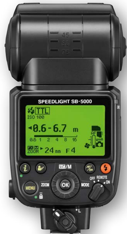
Moderne Kameras können ihre Blitzgeräte wie den Nikon SB-5000 per TTL-Messung steuern. Sie erkennen die notwendige Lichtleistung per Belichtungsmessung durch das Objektiv und beziehen dabei auch die Brennweite und Entfernungseinstellung des Objektivs mit ein.
