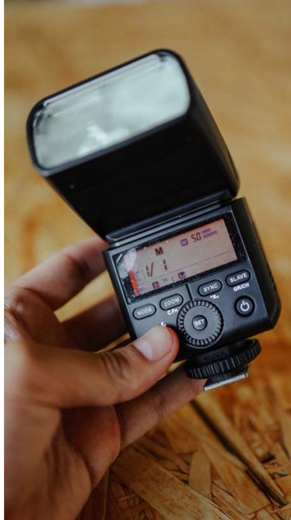
Die Konfiguration eines Systemblitzgeräts erfolgt in der Regel mit einem Drehschalter, Funktionsschaltern und einem kleinen Display.
