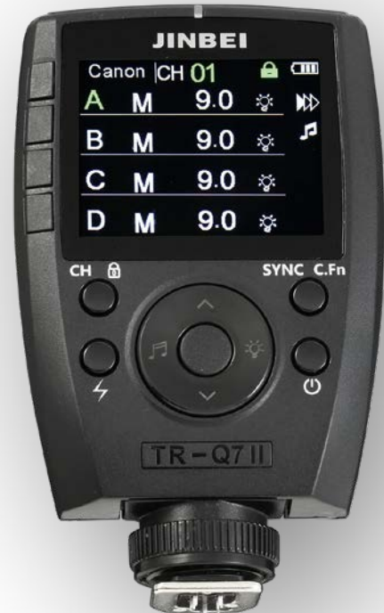
Ein Blitzfernauslöser auf der Kamera wie hier der Jinbei TR-Q7 II steuert Gruppen von Blitzgeräten. Deren Helligkeit kann der Fotograf damit gezielt vorgeben, ohne an die Leuchte herantreten zu müssen.
