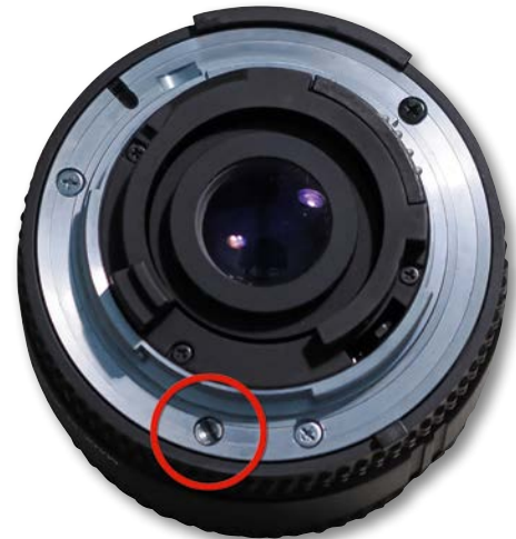
Bei den ersten AF-Systemen befand sich ihr Antrieb in der Kamera. Seine Bewegungen wurden wie hier in einem Nikon-F-Bajonett über eine Kupplung mechanisch ans Objektiv übertragen.
