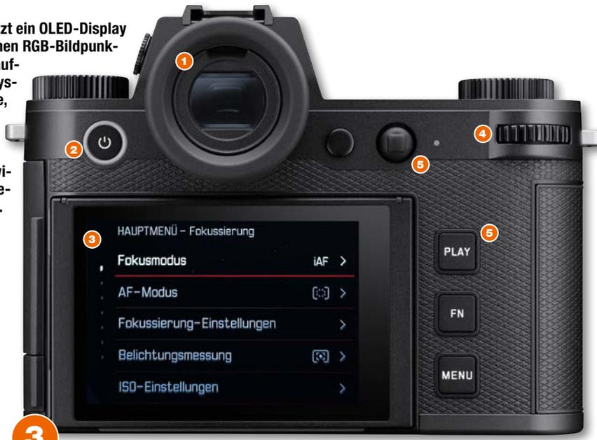
**3** Das LCD mit 2,33 Millionen RGB-Bildpunkten besitzt einen Klappmechanismus, um es um 110 Grad nach oben oder 45 Grad nach unten zu schwenken. Das berührungsempfindliche Display beherrscht die Kamerabedienung mit Wischgesten.
