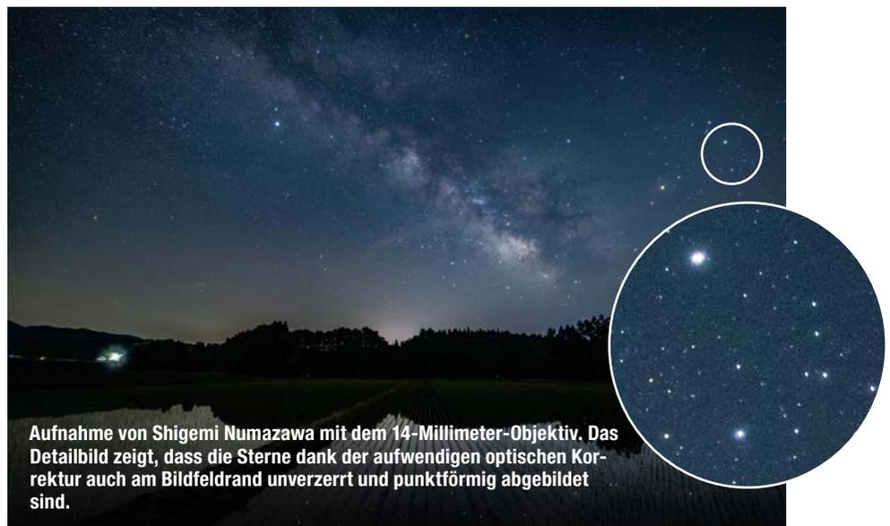
Aufnahme von Shigemi Numazawa mit dem 14-Millimeter-Objektiv. Das Detailbild zeigt, dass die Sterne dank der aufwendigen optischen Korrektur auch am Bildfeldrand unverzerrt und punktförmig abgebildet sind.
