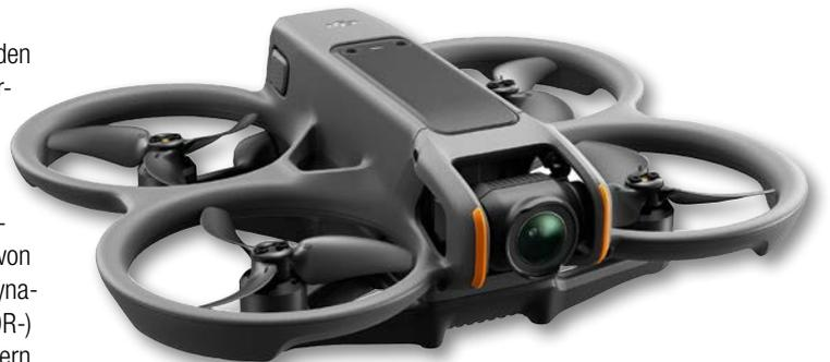
die binokularen Fischaugensensoren stabiler und sicherer. Dank dem „Schildkrötenmodus“ kehrt die Avata 2 nach einer Landung auf dem Rücken automatisch in die Startposition zurück.
