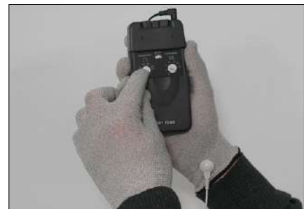
Der Tremor-Simulator erzeugt ein kontrolliertes Zittern und lässt sich genau einstellen.
