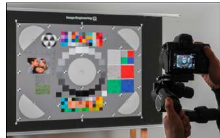
Das Testchart TE42 dient der Überprüfung von Farbtreue, Detailauflösung und vielem mehr.
