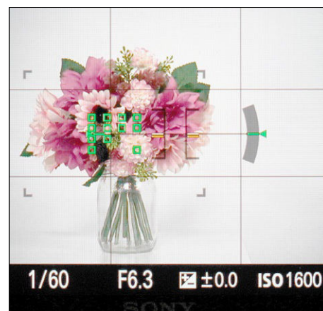
Das große Messfeld lässt sich nach links verschieben, worin die einzelnen Fokuspunkte arbeiten.
