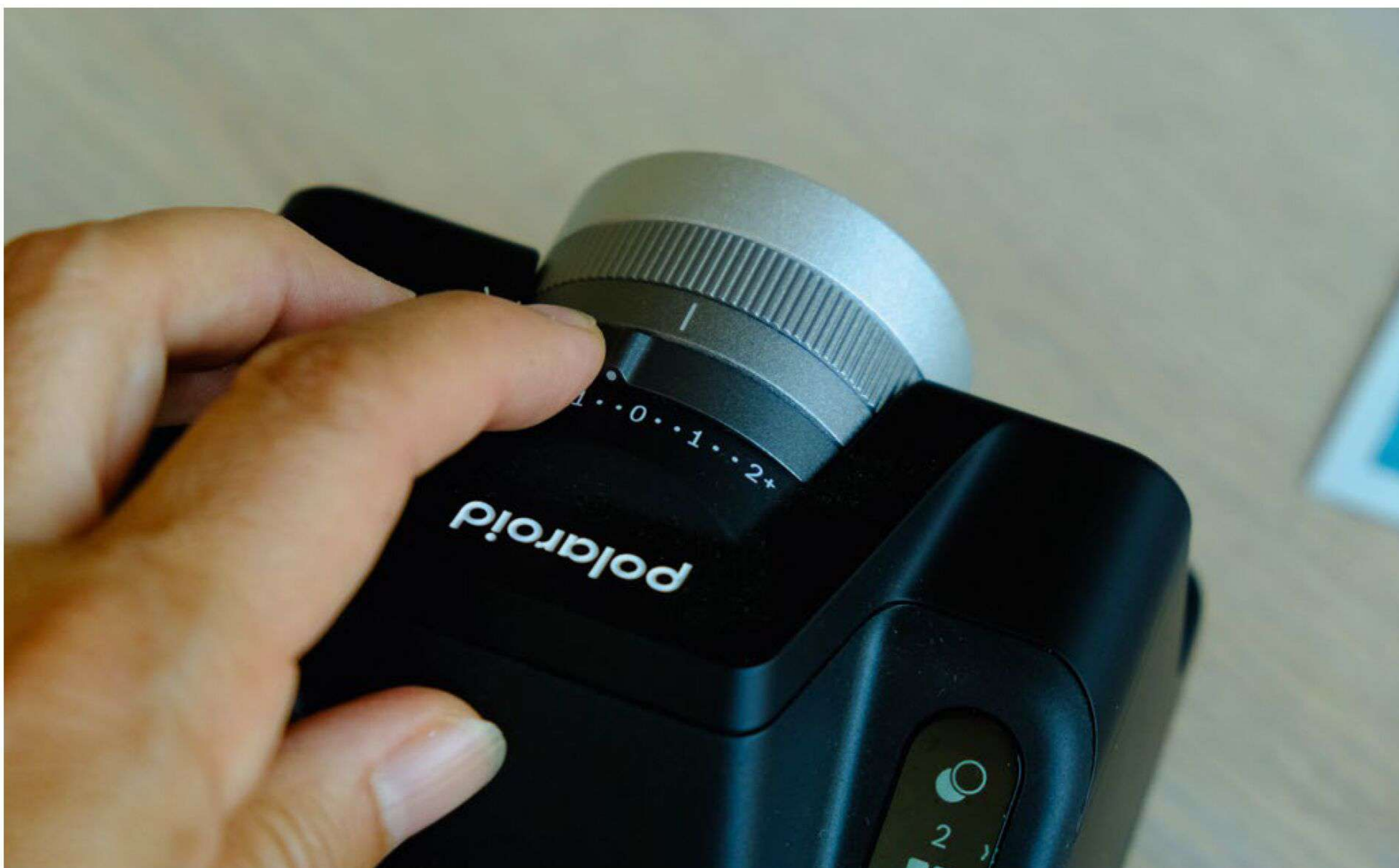
▲ Die Blende und die Belichtungszeit lässt sich durch Drehen am Objektivring der Polaroid I-2 einstellen.
