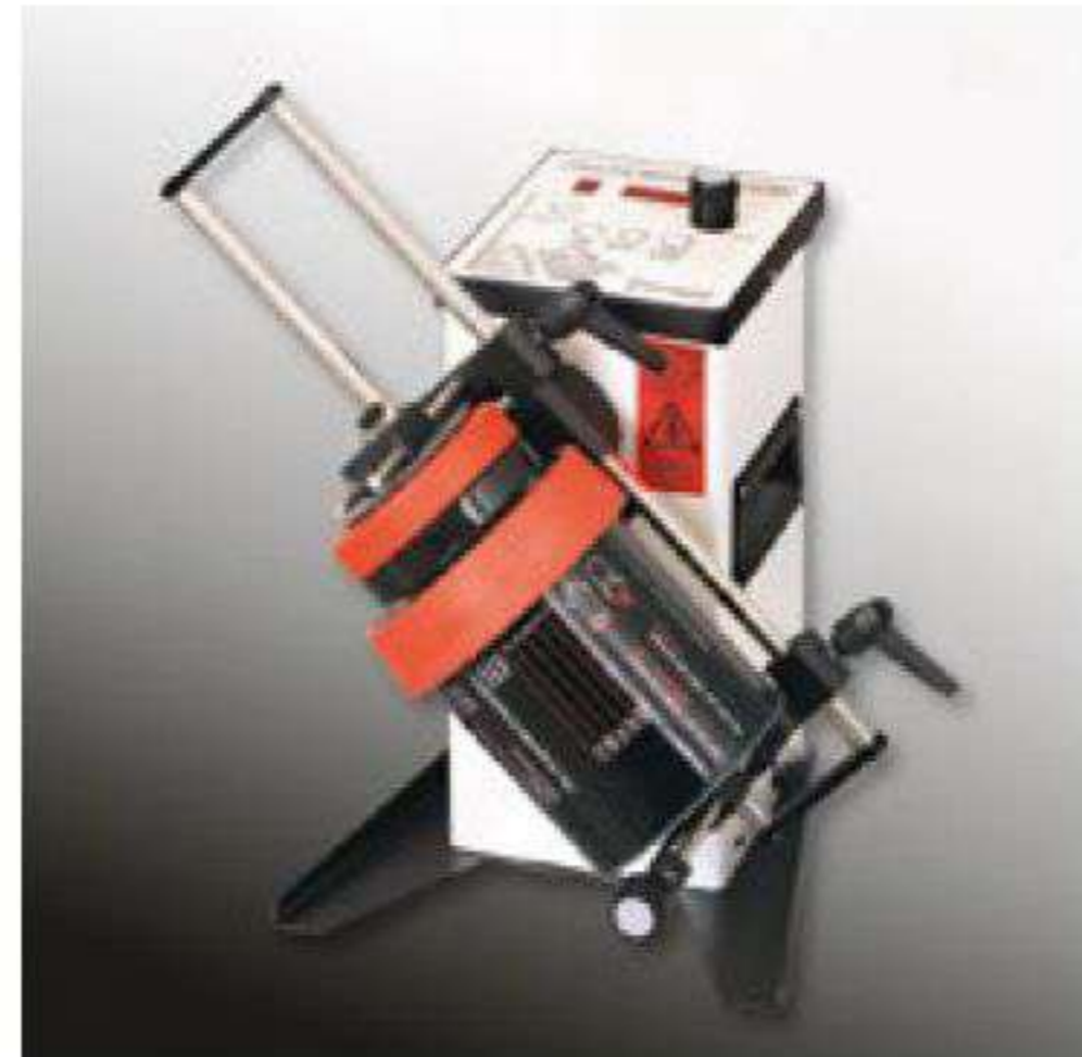
Filme entwickeln mit TAS Prozessor
