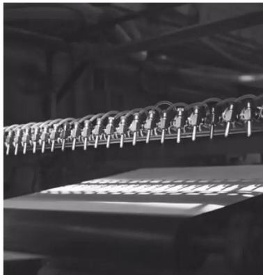
**Blick in die Produktion.** Hier die Büttenspapierherstellung. Die Basis ist ein verdünnter Faserbrei aus Hadern oder Zellstoff.
