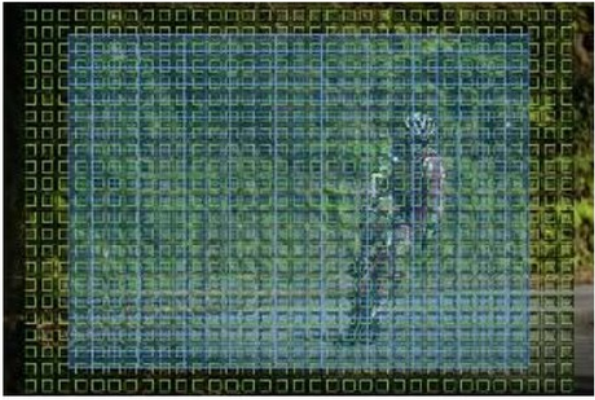
Couverture autofocus du Sony Alpha 1. En vert, les collimateurs agissant par corrélation de phase.
