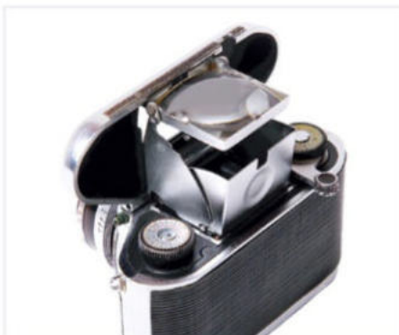
Die Kamera besticht durch ihr helles Sucherbild . Auf der linken Seite neben dem Lichtschacht sitzt der Rückspulknopf mit einer Filmmerkscheibe in DIN und ASA.
