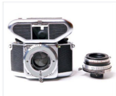
Die Mecaflex in schussbereiter Stellung und mit abgenommenem Normalobjektiv . Es gab eine ganze Reihe hochwertiger Wechselobjektive mit Bajonettanschluss und einiges an Zubehör.
