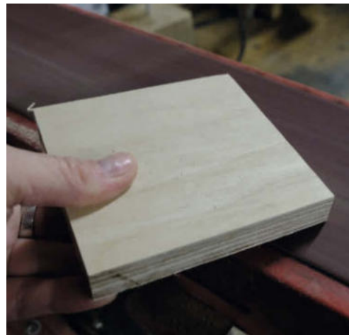
Mit dem Bandschleifer haben wir grobe Kanten geglättet und die Ecken abgerundet.
