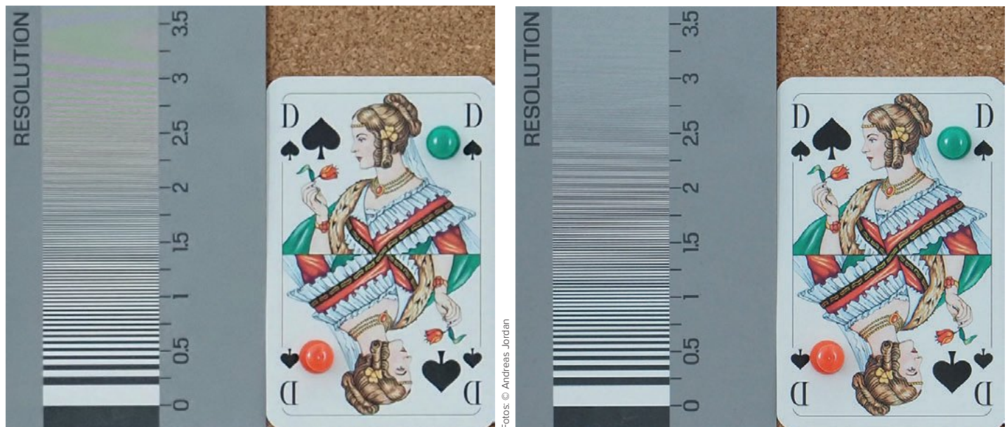
Ausschnitt aus unserem visuellen Testbild: Die High-Res-Aufnahme (rechts) liefert deutlich mehr Details und Schärfe als das normale JPEG (links) und reduziert Bildrauschen und Moirés – hier bei ISO 1600.
